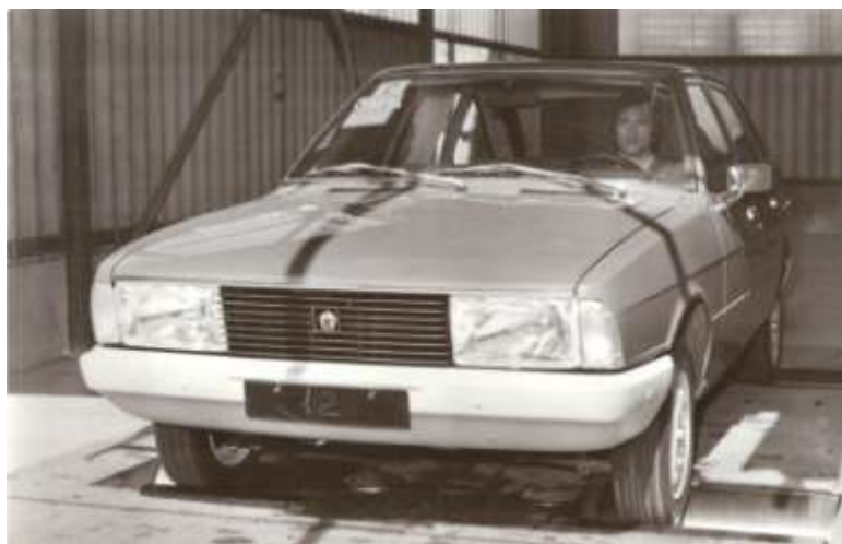
Abb. 15: Test auf dem Rollenprüfstand
