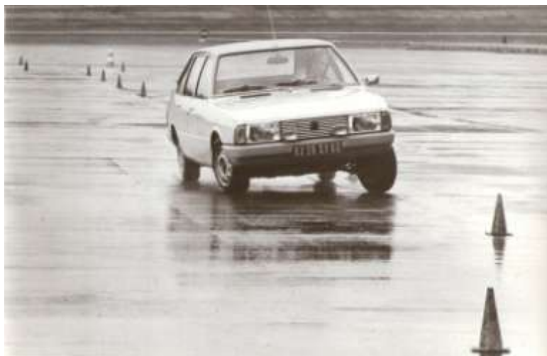
Abb. 17: Slalomtest bei nasser Fahrbahn
