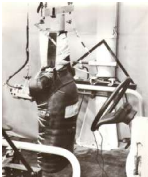
Abb. 12: Prüfung der Bedienbarkeit zur Homologation
