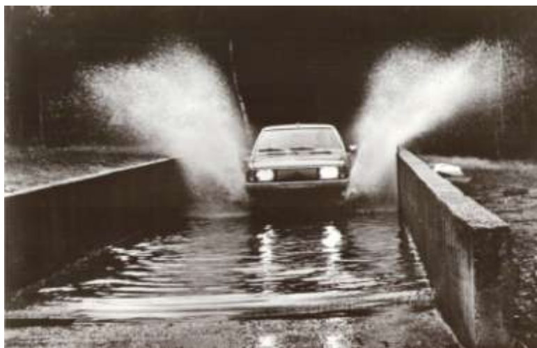
Abb. 18: Durchfahrt durch Salzwasserbad (12 cm tief)
