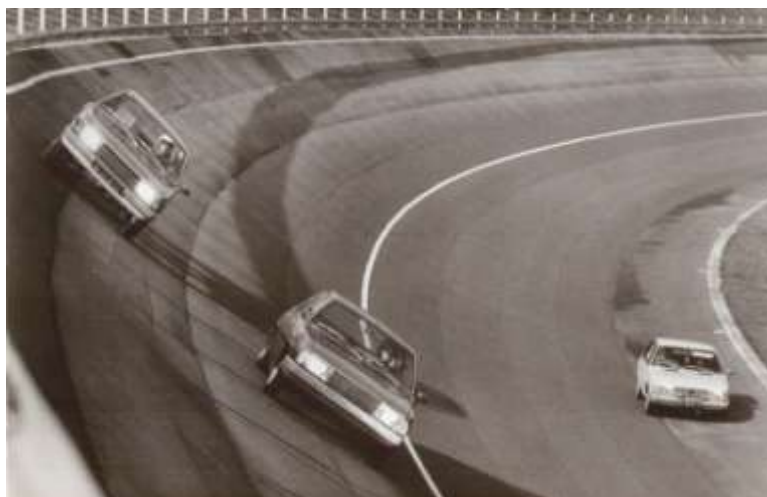
Abb. 19: Geschwindigkeitstests (höchste Bahn = 43° Neigungswinkel)
