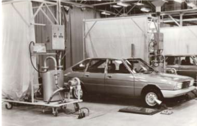
Abb. 16: Test Abgasverhalten nach Europanorm
