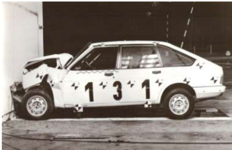
Abb. 14: Crashtest nach Europannorm (50 km/h Frontalaufprall)
