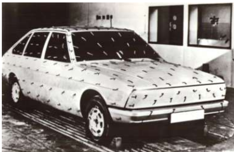
Abb. 9: Windkanaltest mit Tonmodell
